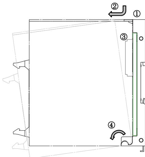
モジュール固定ネジ「①」を外します。
