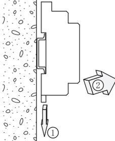
ソケット下部のレールホルダの溝にマイナスドライバー等押し込み、それを下方に押しながらかソケットの下部を手前に引きます。
