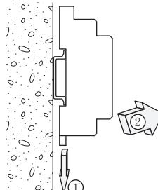
ソケット下部のレールホルダの溝にマイナスドライバ等を押し込み、それを下方に押しながらソケットの下部を手前に引きます。
