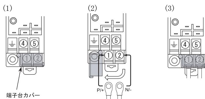
注)安全の為、活線状態での作業は避けてください。締め付け作業後は全ての端子ネジが十分に締まっていることを都度確認してください。
