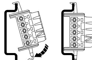
③パワーブリッジの取り付け方向を確認します。
