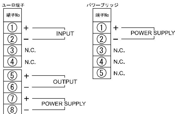
※パワーブリッジを使用する際は必ずAC電源ユニット、DC電源カード、パワーブリッジ対応コネクタの何れかを使用して電源を印加して下さい。また、変換器各々の電源端子には電源を接続しないで下さい。
