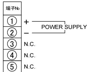
※パワーブリッジを使用する際は必ずAC電源ユニット、DC電源カード、パワーブリッジ対応コネクタの何れかを使用して電源を印加して下さい。また、変換器各々の電源端子には電源を接続しないで下さい。
