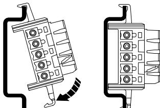
③パワーブリッジの取り付け方向を確認します。
