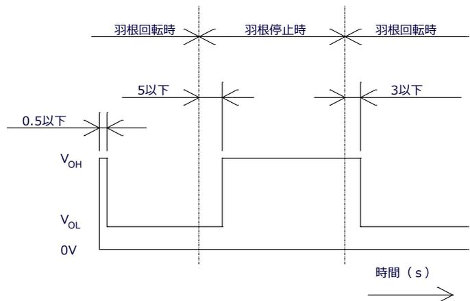
(注) 出力が完全にV<sub>OL</sub>(0.6V 以下)になる
