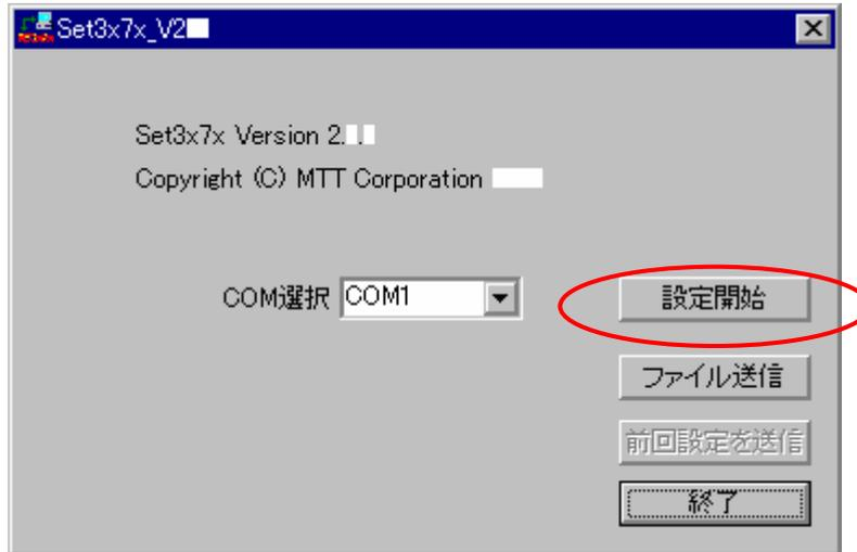
画面右下の「設定開始」ボタンを押すと、モジュールと通信してモジュールの型式や設定情報を取得します。(※1)
