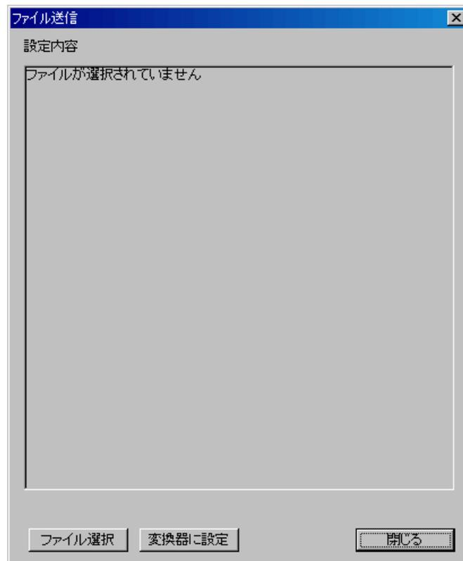
3. 「ファイル選択」ボタンを押して、変換器に送信するファイルを選択します。
