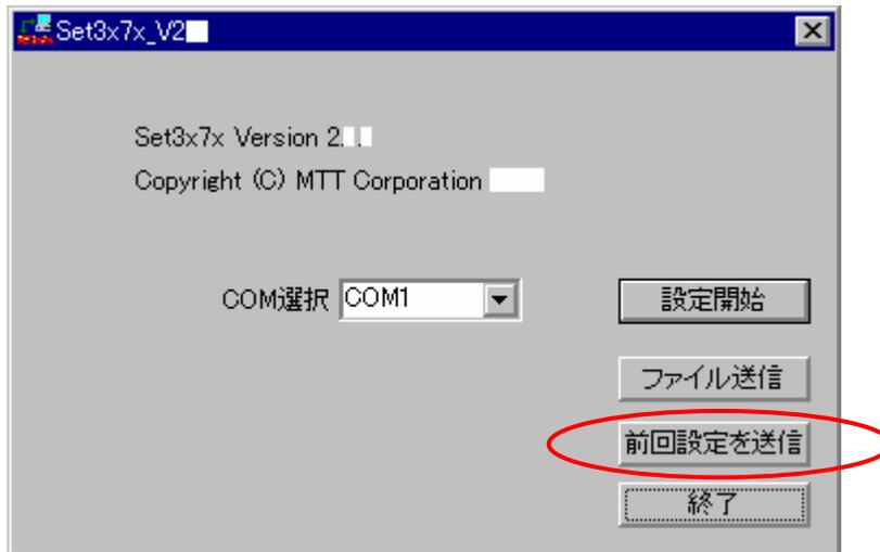
“前回設定を送信” ボタン により複数の変換器に設定を行う場合
